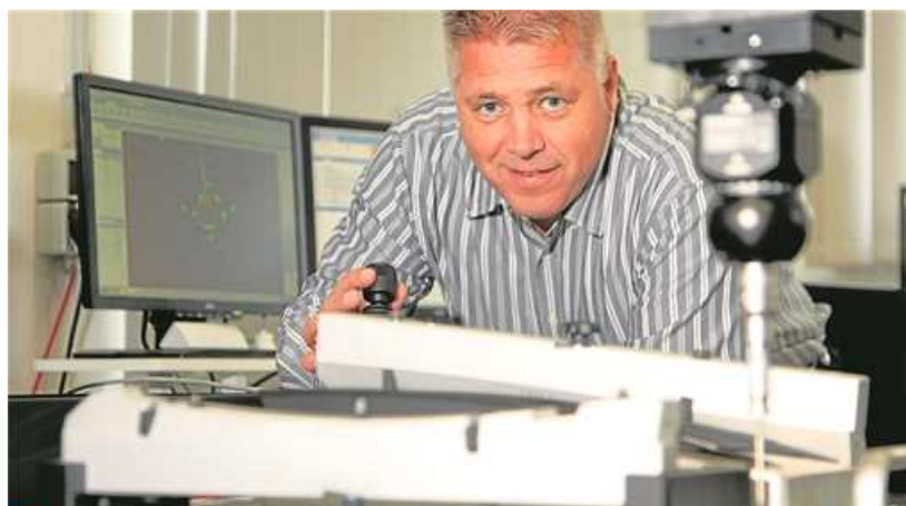
Geschäftsführer Jörg Werkmeister führt die Arbeit der taktil arbeitenden Messeinrichtung vor und vermisst eine Dachleiste, die bald bei einem neuen Volvo-Modell Verwendung findet.
