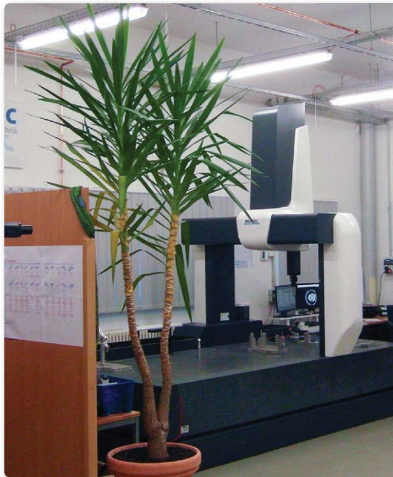
1 | : Nach VDI/VDE 2627 Bl.1 vollklimatisierter, 220 Quadratmeter großer Messraum der Lometec GmbH & Co. KG
