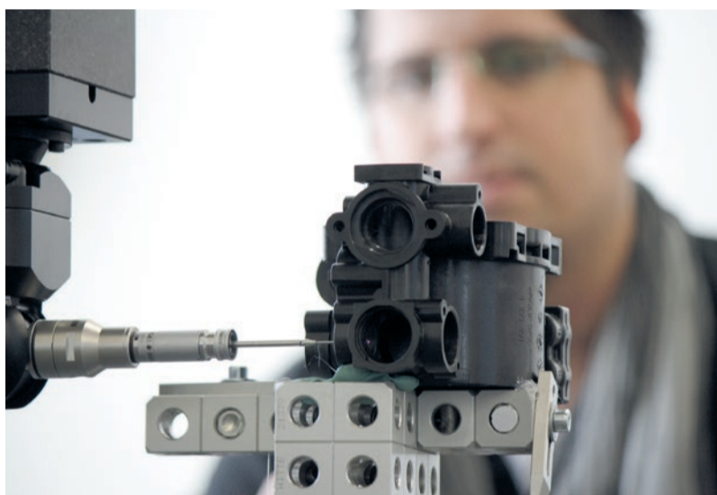
Taktile Messung eines Pumpengehäuses
